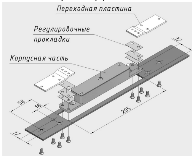
Рисунок 6 - Установка корпуса замка в металлическую коробку
