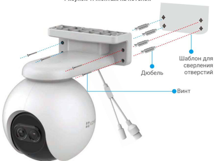
Рисунок 2. Монтаж на стену
