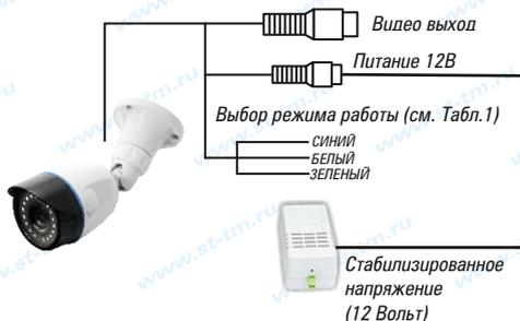
Рис.1 Схема подключения
